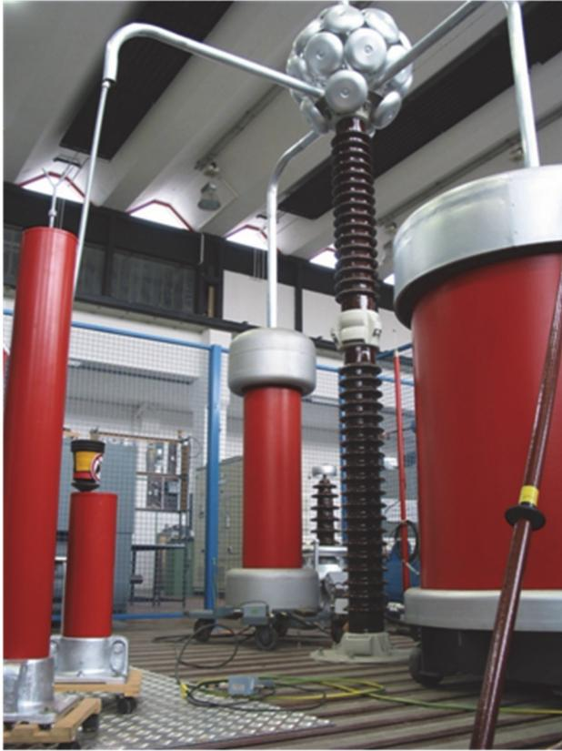
Mobiles Resonanzprüfsystem zur Teilentladungs- und Verlustfaktormessung und Spannungsprüfung
